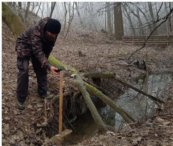
Obr. 48. - Vytvorenie jednoduchého meracieho systému na sledovanie zabahňovania úložiska za kmeňovými
