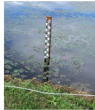
Obr. 42. - Inštalovaný vodočet v Tiszatarjáne. (Foto: samospráva obce Tiszatarján)
